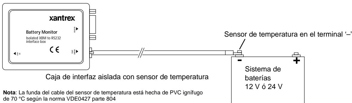
**Nota:** La funda del cable del sensor de temperatura está hecha de PVC ignífugo de 70 °C según la norma VDE0427 parte 804
