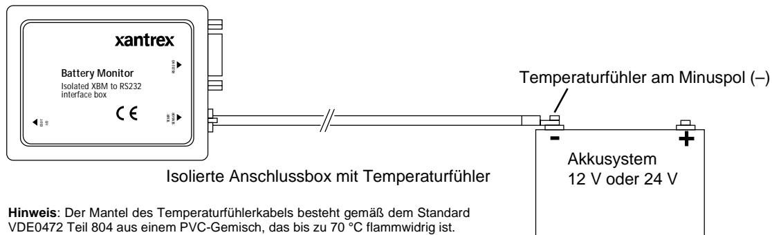
**Hinweis:** Der Mantel des Temperaturfühlerkabels besteht gemäß dem Standard VDE0472 Teil 804 aus einem PVC-Gemisch, das bis zu 70 °C flammwidrig ist.
